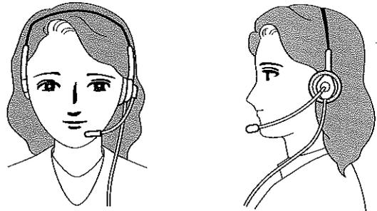
送話器の位置は唇の斜め前方にくるように送話ケーブルにより調節してください。このとき送話ケーブルを回転させると送話器ケースのマイクロが唇の方向から外れますので、注意してください。
